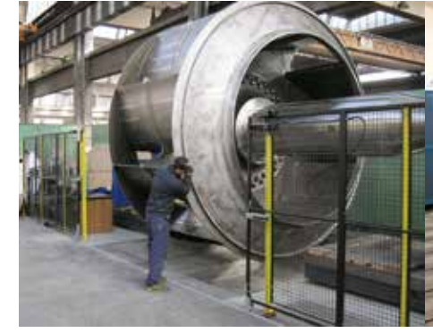
BOOSTER FAN DESOX
